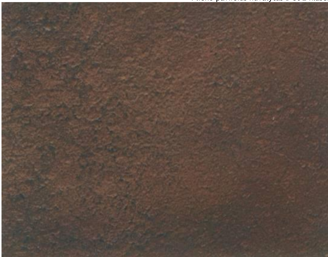
Plieno paviršius nuvalytas D St 3 klasės
